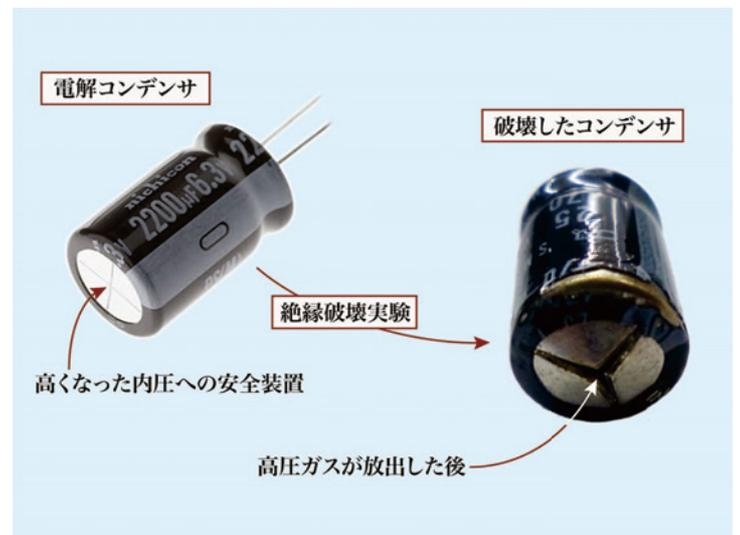
写真2 絶縁破壊前後の電解コンデンサの変化
